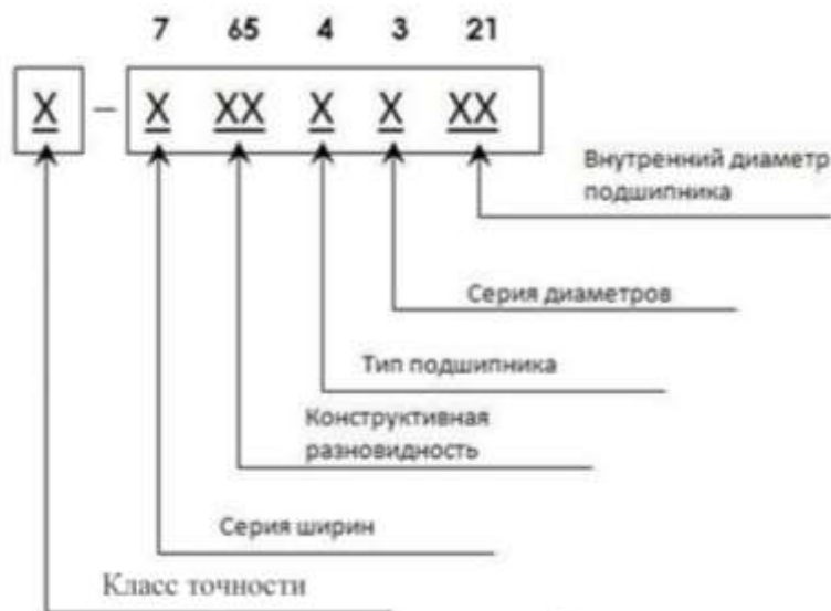
Рисунок 2.6 – Схема условного обозначения подшипников качения
